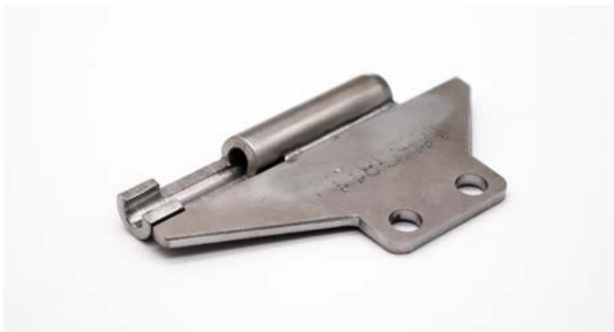
Kovový vozík vyrobený na 3D tiskárně
